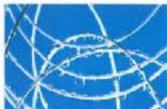
7 faisceaux cylindriques, totalisant 28 000 membranes soit près de 36 km de fibres, sont rassemblés dans chaque module.
